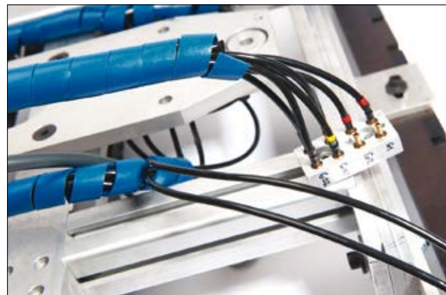
Detecteerbare, metaalhoudende spiraalslang beschermt bekabeling in levensmiddelenapplicaties.
