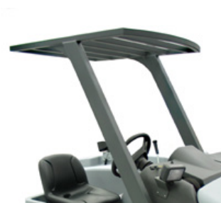
Chauffeursbeveiliging Beschermt de bestuurder
