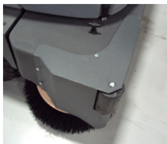
Hoekbeschermers zijborstel Beschermt zowel machine als zijborstel
