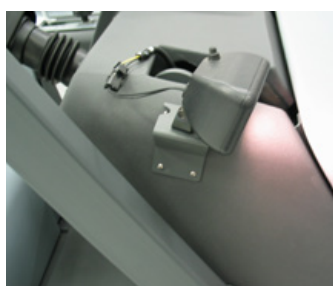
Werkverlichting voor Deze verlichting geeft extra zicht op de vloer, ondersteunt de gewone verlichting
