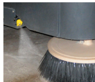
DustGuard™ kit Om stofvorming bij de zijborstel te voorkomen (niet voor alle modellen beschikbaar)
