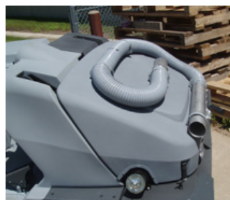
Zuigbuis Bedoeld voor het reinigen van moeilijk bereikbare plaatsen zoals laad-, en losperons, trappen en stellingen
